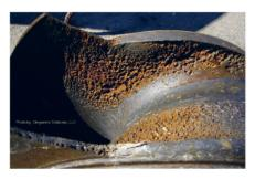
Fig. 5.10. Cavitaion damage on an impeller
